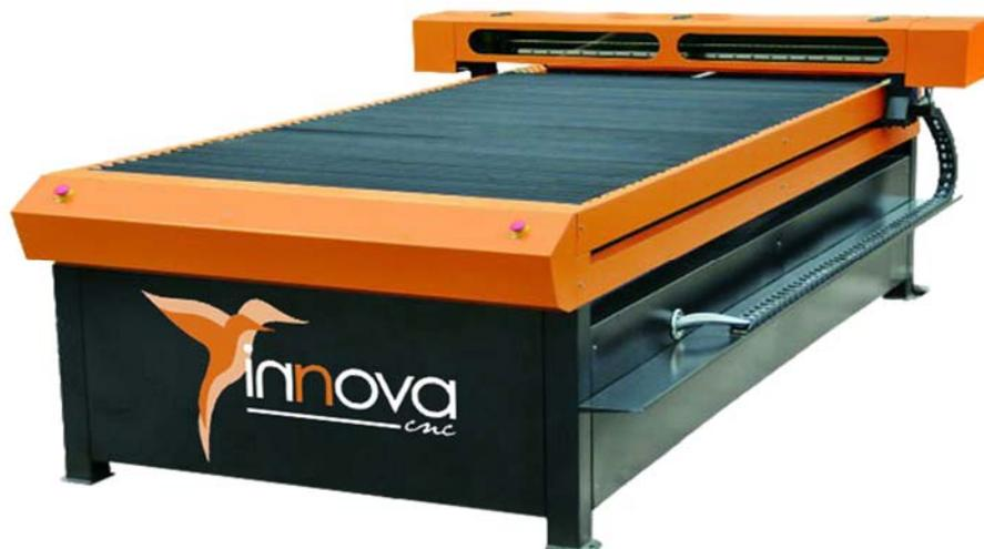
La serie Lasercut ECO pertenece a la gama básica de máquinas profesionales láser de CO<sub>2</sub> de baja potencia. Su estructura compacta, mesa con sistema de aspiración selectorizado, alta velocidad de desplazamiento, bajo coste de mantenimiento y una potencia láser de 400W hacen de estos modelos una solución económica, versátil y rentable para multitud de aplicaciones, industrias y sectores.
